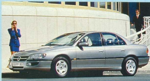
"Опель-Омега-MV6" с 6-цилиндровым V-образным двигателем (2962 см 3 , 210 л. с.) развивает до 230 км/ч и расходует при скорости 120 км/ч всего 8,7 л/100 км.
