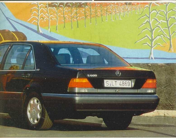
"Мерседес-Бенц-S600". Одна из самых мощных серийных машин с двенадцатицилиндровым двигателем мощностью 394 л. с./290 кВт. Цена — от 202 тысяч немецких марок.
