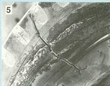
Рис. 7. Повреждение металлического сердечника борта.
