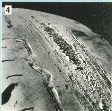
Рис. 2. Сквозное повреждение беговой дорожки.
