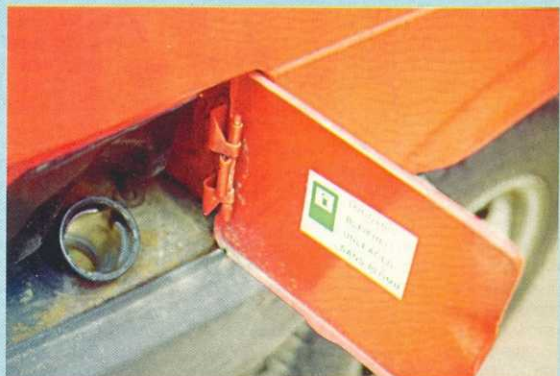
Надпись на лючке бензобака напоминает, что можно заливать только неэтилированный бензин. В горловине установлен клапан, ограничивающий диаметр заправочного пистолета.
